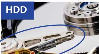
HDD磁気ヘッドを、数十ナノメートル単位で位置決めする極限レベルの精度要求に対応
