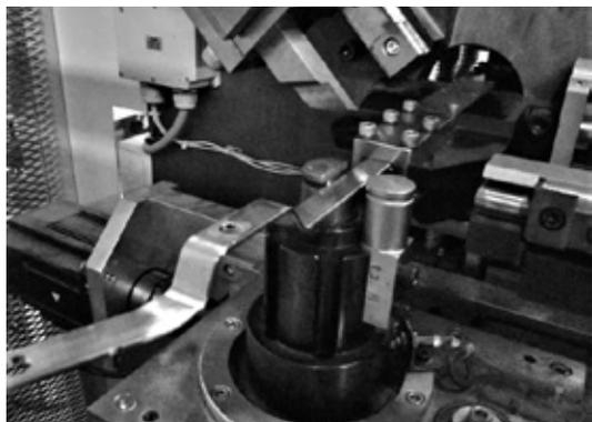
写真5 自社開発のフォーミングマシンによるバスバーの加工光景
