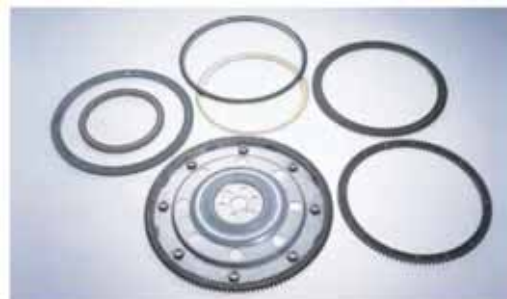
エンジン始動時、セルモーターによる動力をエンジンに伝える部品です。 ※セルモーター→リングギヤ→クランクシャフト→コンロッド→ピストンという伝達経路でピストンを動かしてエンジンを始動させる。
