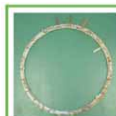
インシュレータワイヤ インバーターから送られてきた電力をモーターコイルへ電気を分配するための導線です。
